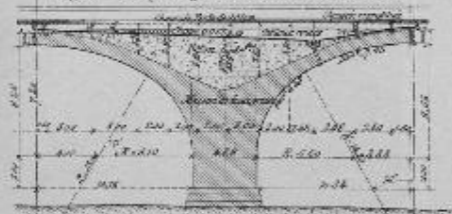
Fig. 8. — Coupe longitudinale de deux demi-voûtes.
